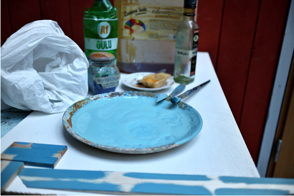
Kuva 22: Uudet värisävyt sekoitettiin kylmäpuristettuun pellavaöljyvernissaan. Väriaineina käytettiin perinteisiä kuivapigmenttejä, jotka hierrettiin vernissan kanssa tahnaksi ja laimennettiin maalattaviksi. Alin maalikerros ohennettiin puutärpätillä, jotta maali imeytyisi paremmin puuhun. Sekoitussuhteena testattiin aluksi 1:1, mutta lopullisessa maalissa oli vernissaa enemmän kuin tärpähtiä. Maalin homehtumisen estämiseksi kaikkiin värisävyihin sekoitettiin sinkkivalkoista. Kuiviketta ei käytetty, vaan maalit saivat kuivua oman aikansa jokaisen maalauskerroksen välillä.
